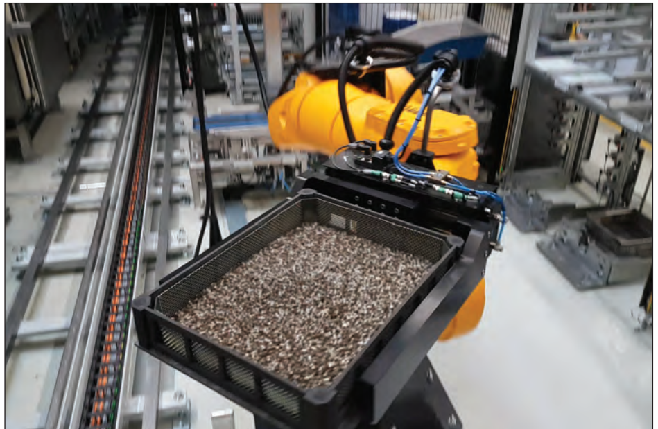
Tratamiento automatizado de piezas pequeñas y diversas piezas en las líneas de producción
